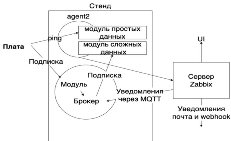
Рис. 1. Архитектура системы отслеживания ошибок
